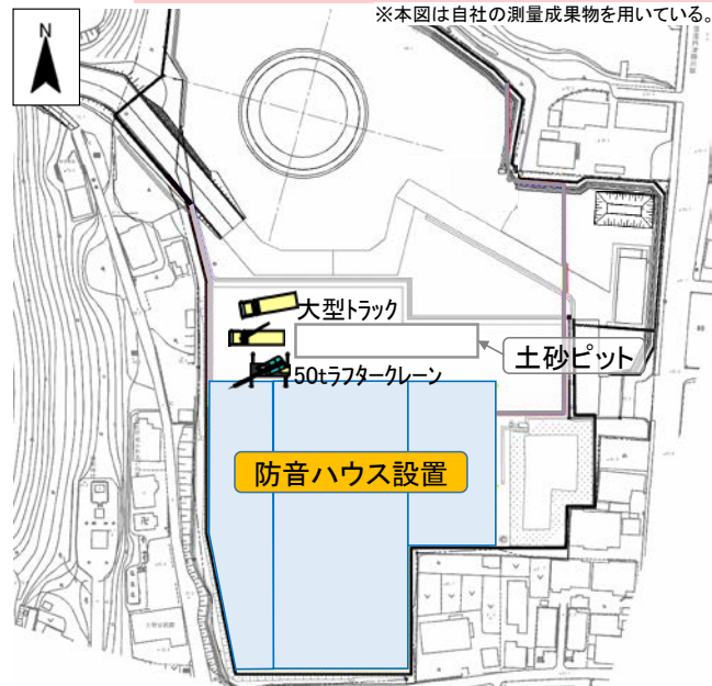
図 2-4(4) トンネル掘進準備工事の施工位置及び手順（写真は類似工事の例）
