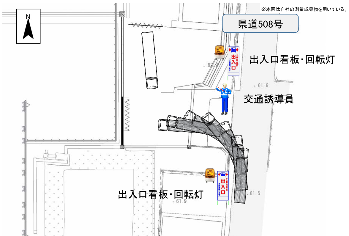
図 2-10 国道 19 号側出入口の交通誘導員の配置
