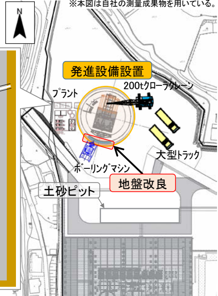
図 2-4(7) トンネル掘進準備工事の施工位置及び手順 (写真は類似工事の例)
