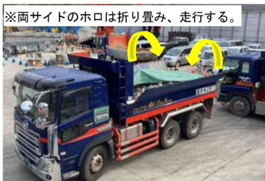
写真② 荷台への防じんシートの設置
