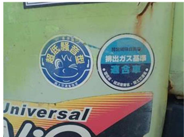
写真⑤ 排出ガス対策型、 低騒音型建設機械の使用
