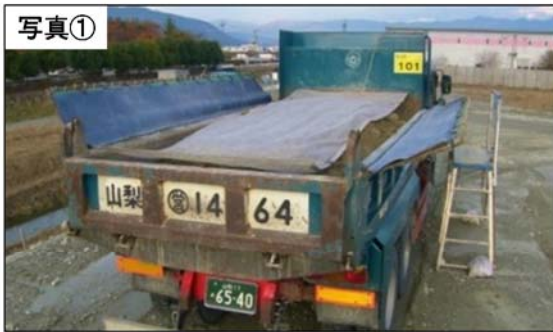
荷台への防じんシートの設置
