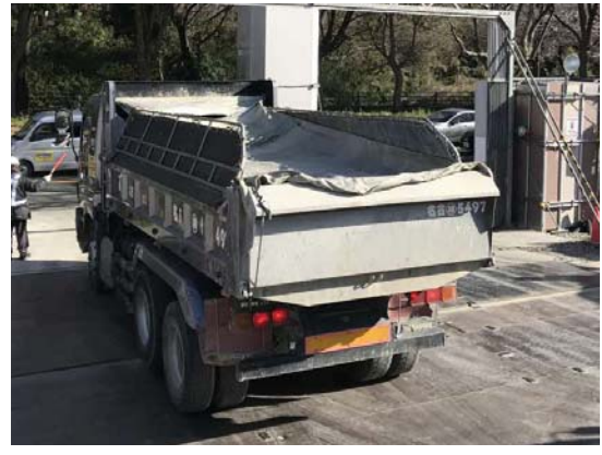
写真7-1-2-6 荷台への防じんシート敷設及び散水
