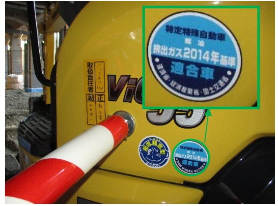
写真 7-1-3-2 排出ガス対策型建設機械の採用
