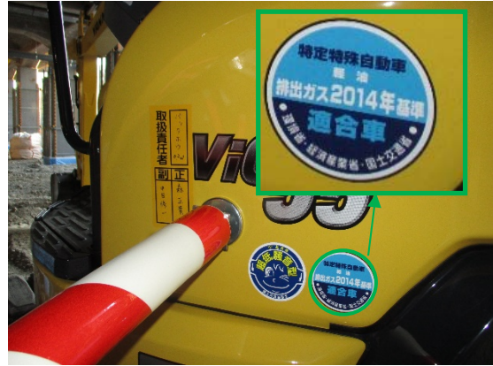
写真 6-1-2-2 排出ガス対策型建設機械の採用
