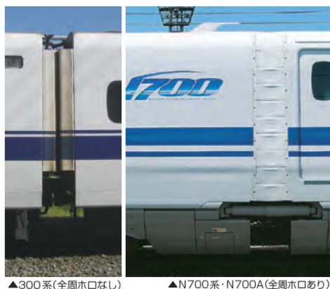
図 19-3-2-2 車両の平滑化による走行抵抗の低減の一例
