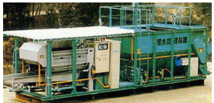
水質：濁水処理装置の設置の例 「株式会社檜崎製作所HP」より
