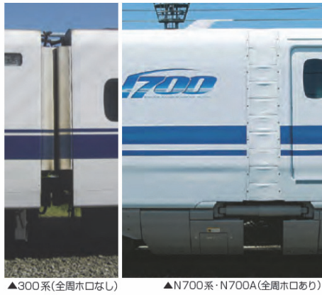
図 13-3-2-2 車両の平滑化による走行抵抗の低減の一例
