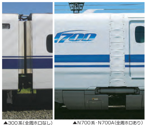
図 24-3-2-2 車両の平滑化による走行抵抗の低減の一例
