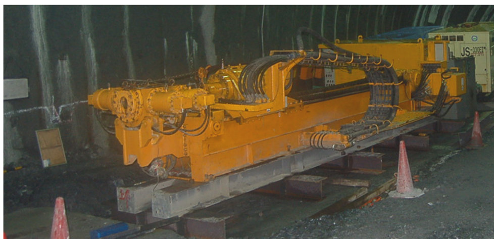
図 7-5-2 先進ボーリングマシン
