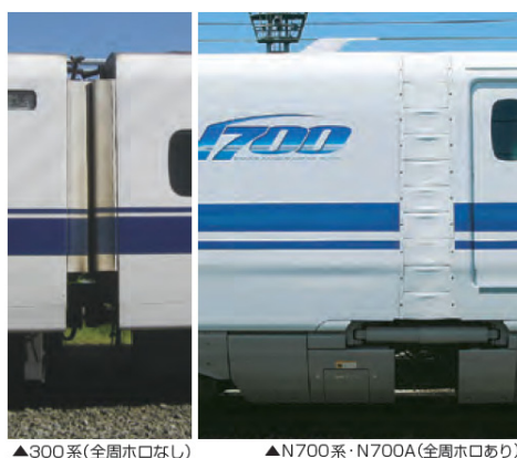
図 19-3-2-2 車両の平滑化による走行抵抗の低減の一例
